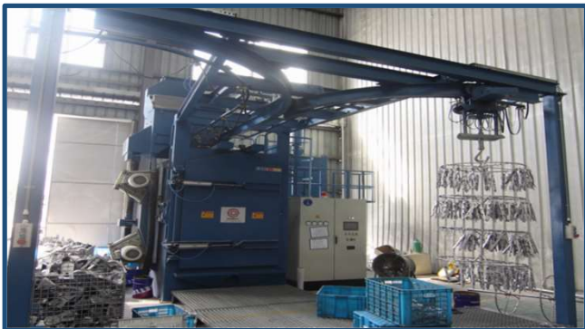
ブラスト Shot Blasting
